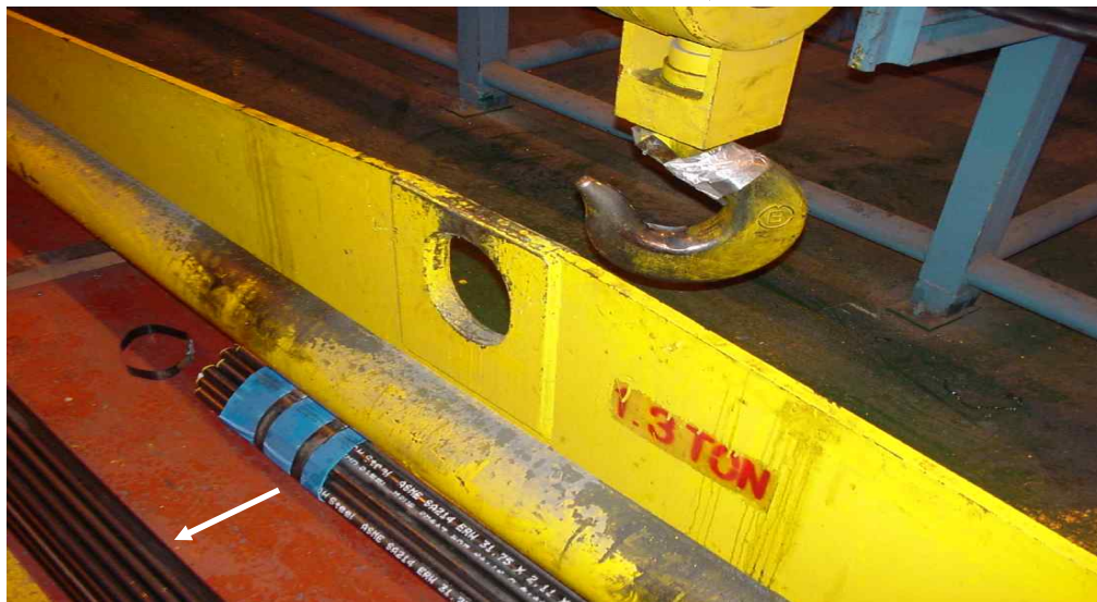
<사진 1 : 핸들링지그 재해자 쪽으로 낙하, 낙하높이 : 1.4m>
