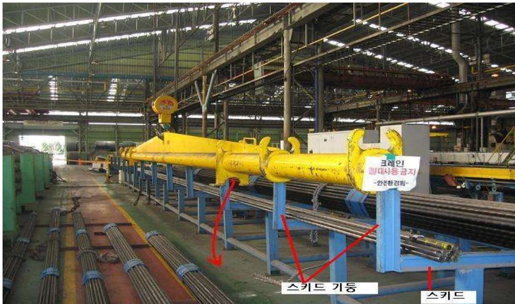
<사진 1 : 핸들링지그 재해자 쪽으로 낙하, 낙하높이 : 1.4m>
